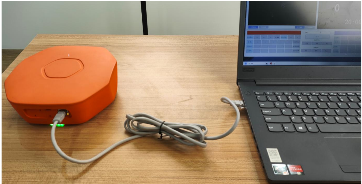
图 2.1 网线直接方式
